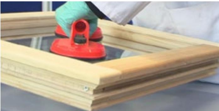
La prise instantanée permet à la fenêtre d'être manipulée rapidement après la mise en place du silicone
